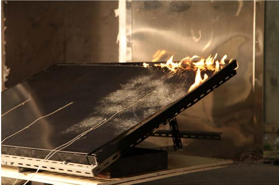
図 7-17 モジュール No.4 助燃剤燃焼終了後の状態
