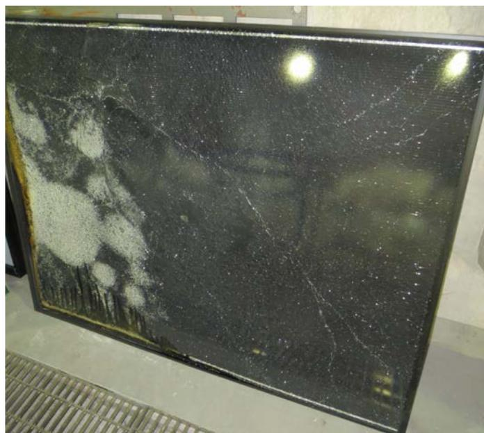
図 7-18 燃焼後モジュール No.4 表面の状態
