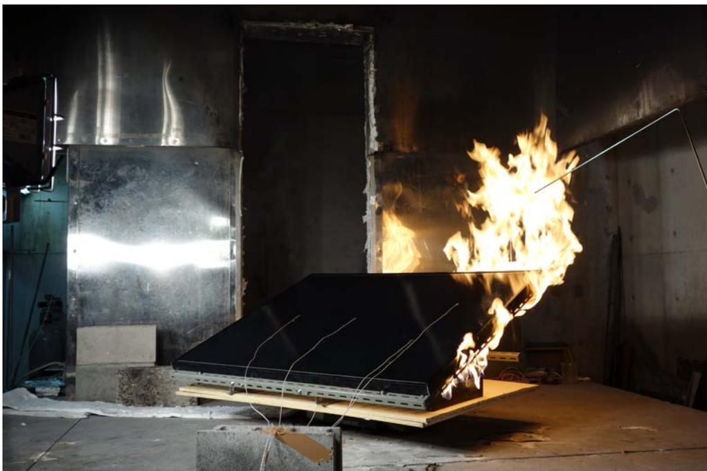
図 7-16 モジュール No.4 燃焼の状態
