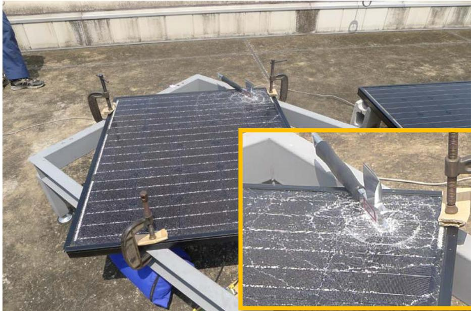
図 7-1 万能斧①の先端が貫通した単結晶シリコンモジュール
