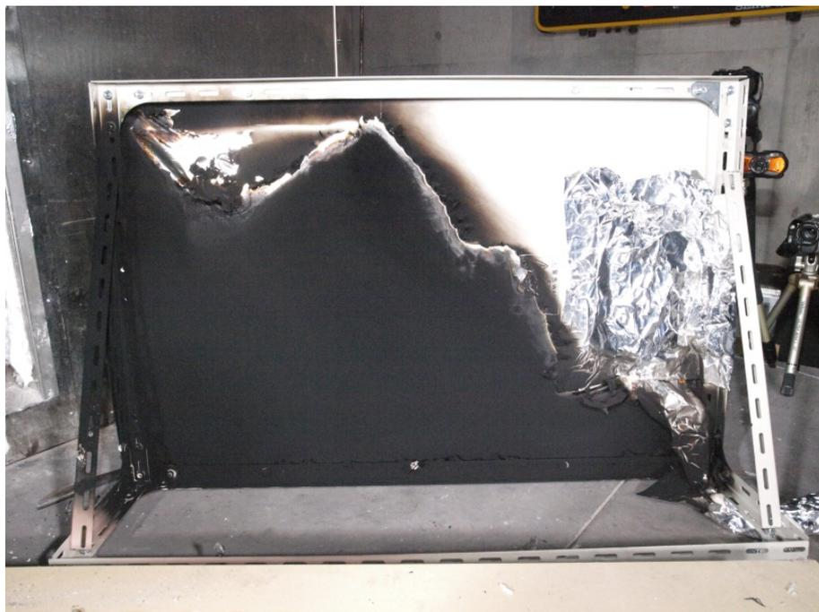
図 7-7 燃焼後のモジュール No.1 裏面の状態
