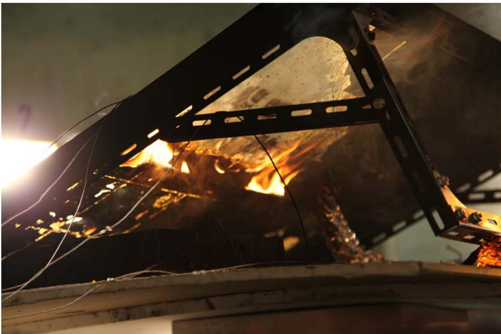
図 7-10 モジュール No.2 助燃剤燃焼終了後の状態
