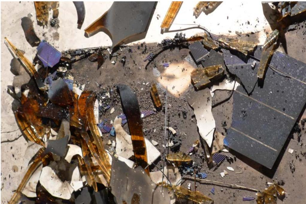
図 7-12 燃焼後のモジュール No.2 より欠落したガラスと太陽電池セル
