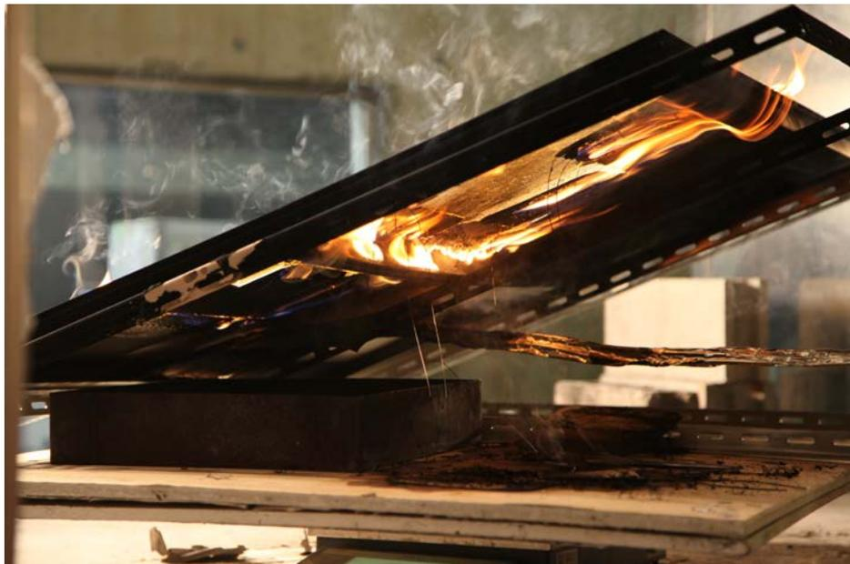
図 7-14 モジュール No.3 助燃剤燃焼終了後の状態
