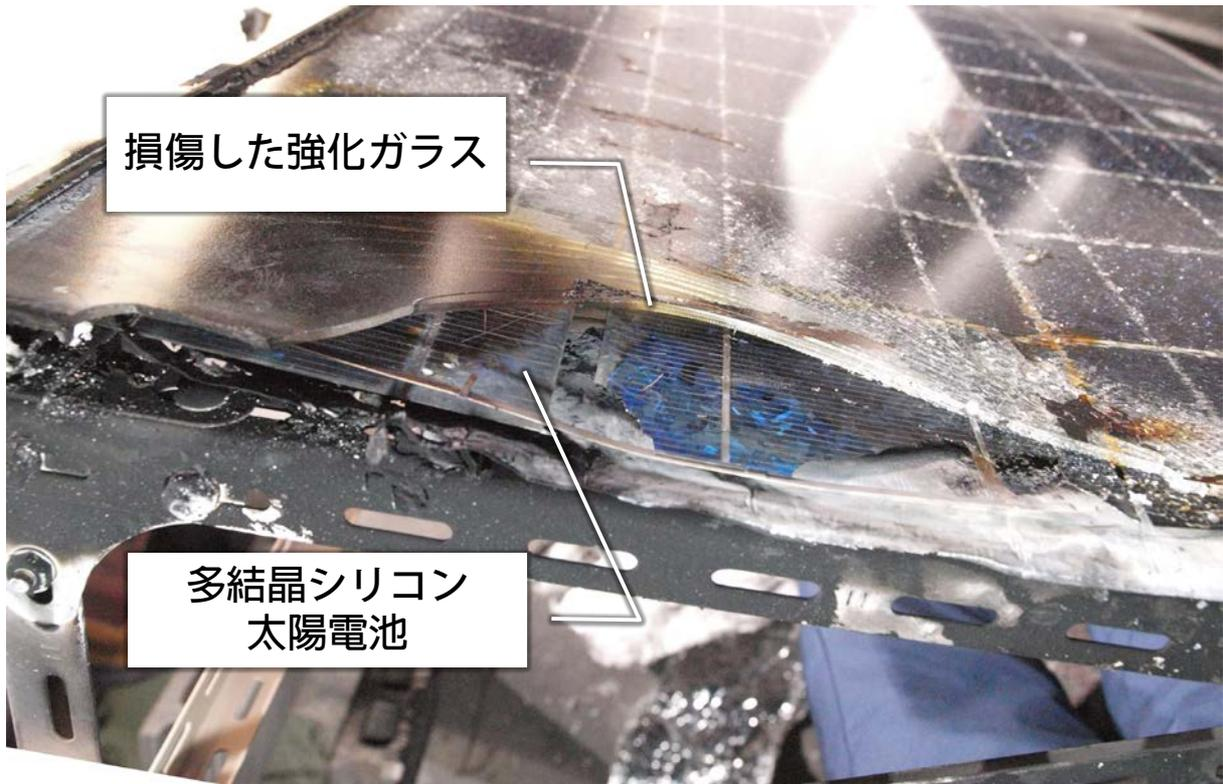
図 4-11 燃焼後のモジュール大の損傷の様子
