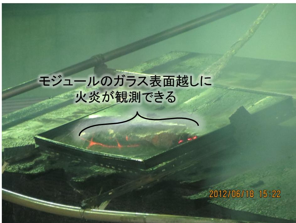
(b) モジュールの裏面で燃焼が継続
