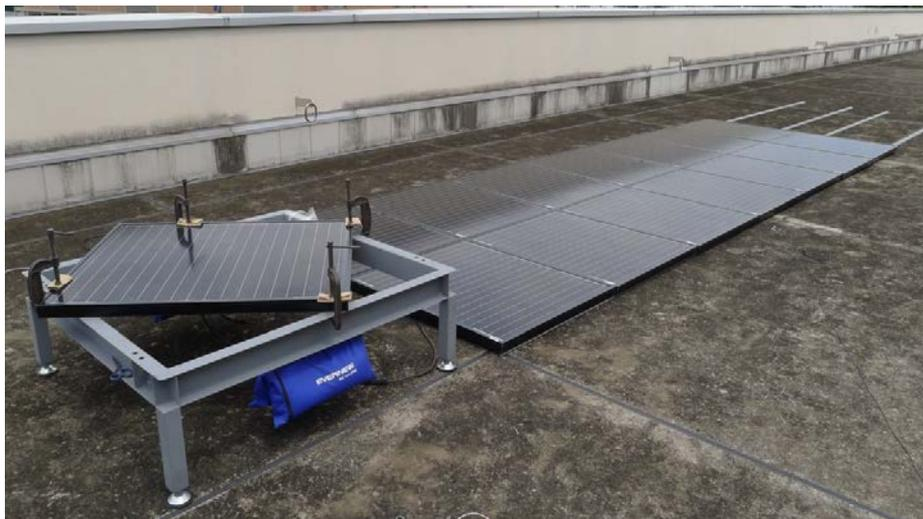
図 10-9 破壊する単結晶シリコンモジュールを含めモジュール 15 枚を並べた実験装置
