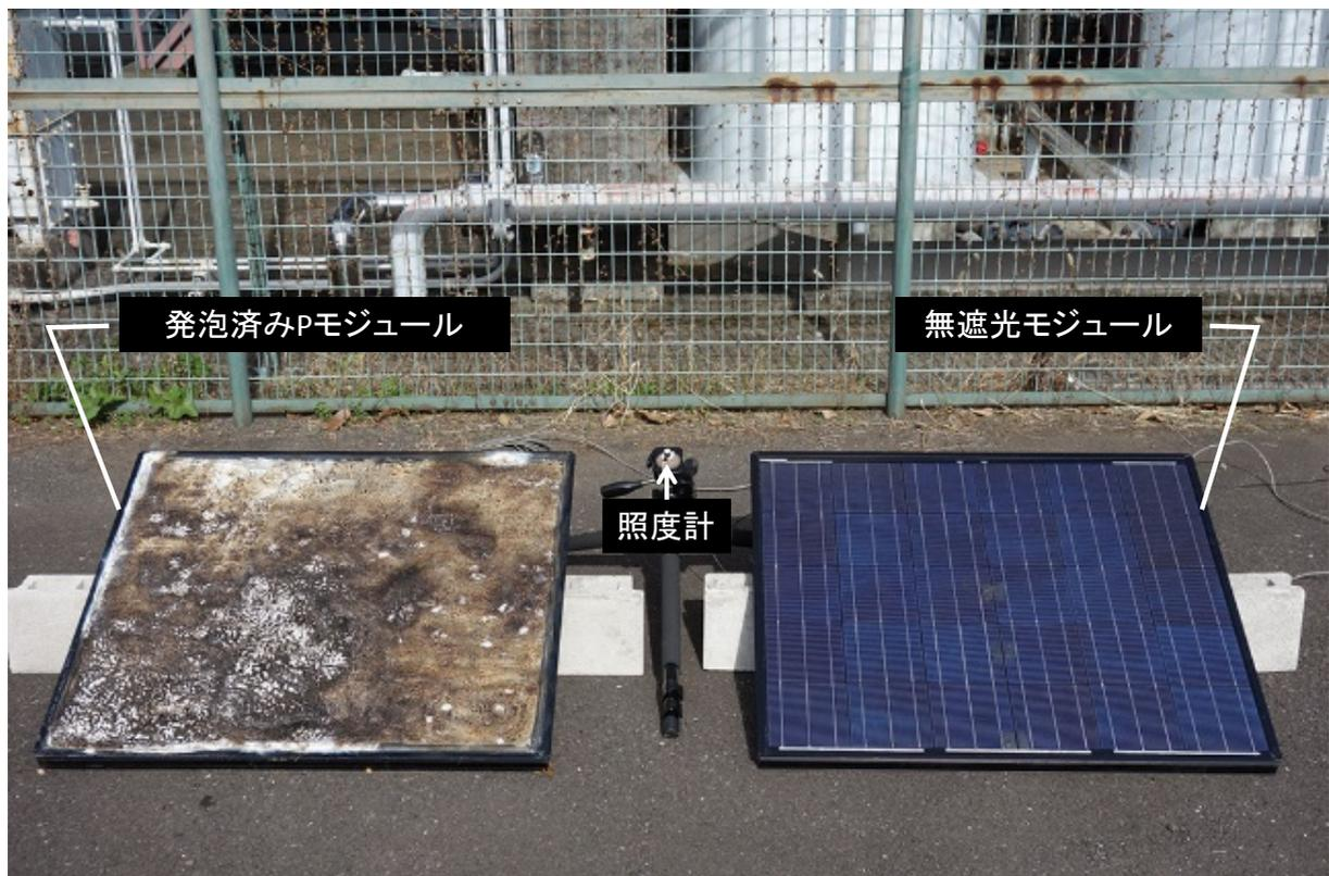
図 11-9 発電抑制効果実験の実験装置
