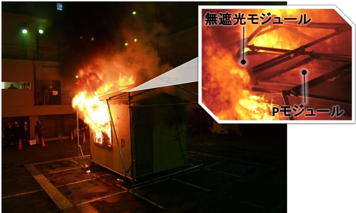
図 11-7 モジュール出力電圧最大時のモジュールの火炎曝露状況
