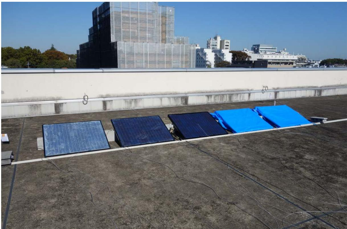
図 11-2 種々の遮光物による発電抑制比較実験の様子
