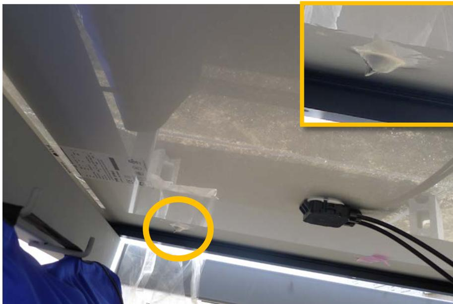
図 7-4 万能斧①の先端部が貫通した CIS モジュールを裏側から見た様子（丸の中）。
