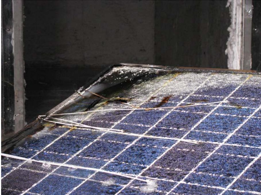
図 7-8 燃焼後のモジュール No.1 表面の状態
