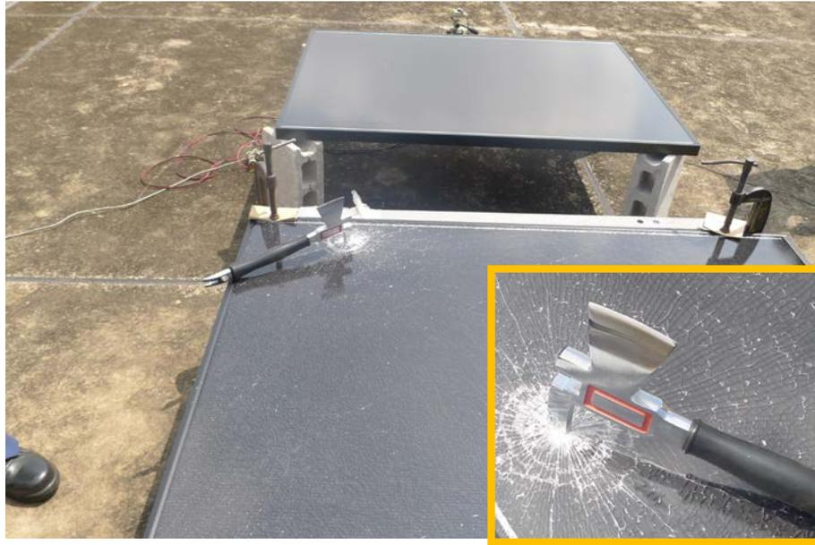
図 7-3 万能斧①の先端部が貫通した CIS モジュール。
