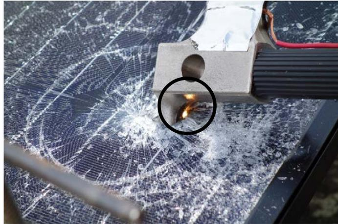
図 10-11 万能斧③による単結晶シリコンモジュールの破壊
