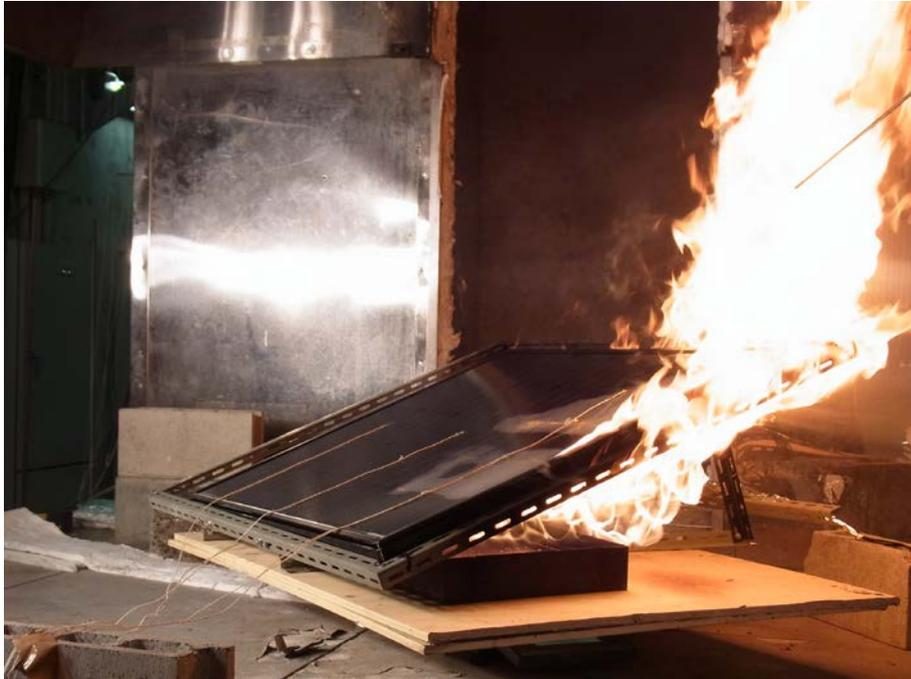
図 7-13 モジュール No.3 燃焼の状態
