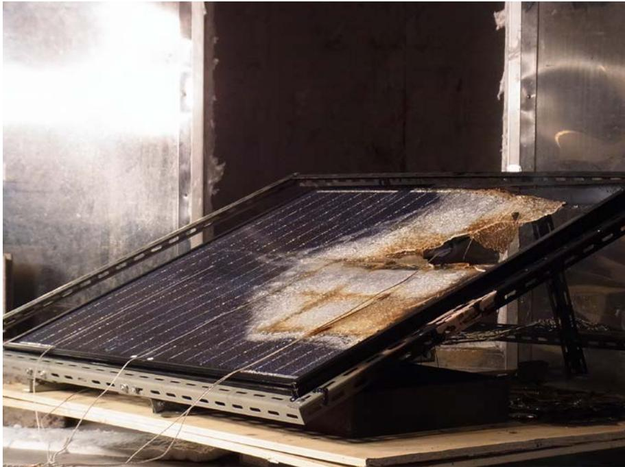
図 7-15 燃焼後のモジュール No.3 表面の状態
